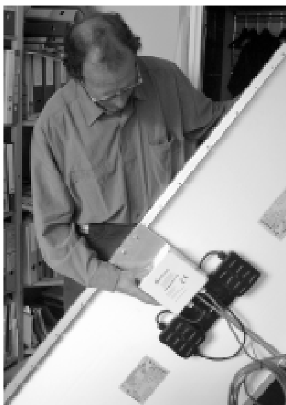
Rückseite des "Mini-Kraftwerks" mit Anschlussdosen und Kleinwechselrichter, Bild Alan C. Hawkins
