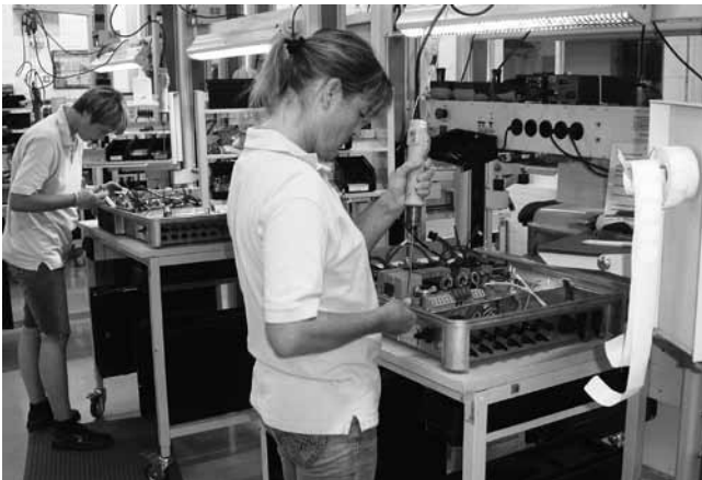
Montage von SolarMax Wechselrichtern
